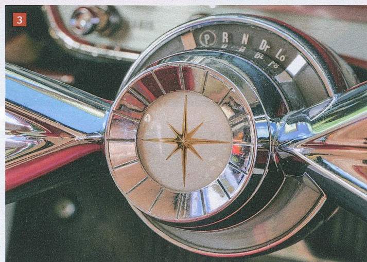
1. Deko-Elemente in der Form von europäischen Wappen waren in den USA äußerst en vogue. 2. Bei der Benennung der Bedienelemente wurde mit 3D-Schriften enormer Aufwand betrieben. 3. Als „Turbo-Drive“ bewarb Lincoln das wassergekühlte 3-gängige Planetengetriebe der Automatik. „Lo“ bedeutet: Anfahren im 2. Gang auf schlüpfrigem Untergrund. 4. Diskret hinter dem hinteren Nummernschildhalter platziert: der Tankeinfüllstutzen. 5. Eine Gesetzesänderung machte es für Modelle ab 1957 möglich: vier Scheinwerfer, von Lincoln „Quadra Lite“ genannt. 6. Die Ventile des 6-Liter-V8 sind rotierend gelagert, um Verschleiß bei geringen Drehzahlen vorzubeugen.
