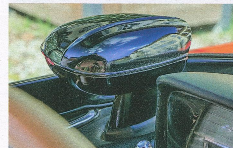
Auf der Fahrerseite sitzt der Sensor der Abblendautomatik für das Fernlicht.
